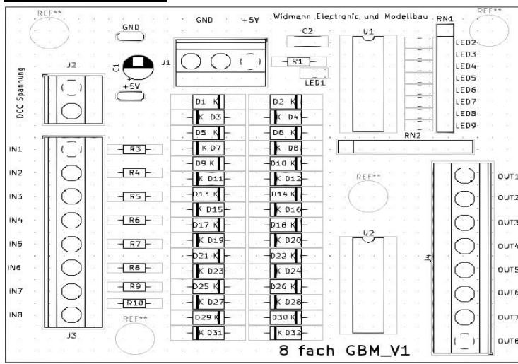
Der GBM dient zur Überwachung von 8 voneinander unabhängigen Gleisabschnitten. Der Gleisabschnitt der zu überwachen ist wird mit Digitalstrom versorgt. Sobald sich eine Lok oder ein anderer Stromverbraucher auf dem Gleisabschnitt befindet wird ein Ausgang des GBM bestromt.
